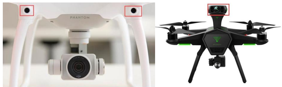
图24: 大疆精灵、零度的避障系统
